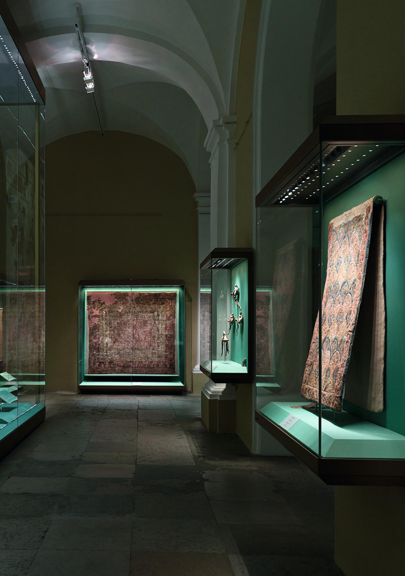
Eine besondere Leistung stellt die Großraumvitrine für den größten ausgestellten geknüpften Teppich dar. Sie hat eine Grundfläche von 8 mal 1 Meter und ist 6 Meter hoch. Auf Grund der Raumsituation boten sämtliche bekannten Öffnungstechniken keine Lösung. REIER entwickelte also Faltschiebetüren, die trotz eines Gewichtes von einer Tonne pro Scheibenpaar von einer einzigen Person mühelos bedient werden können.
